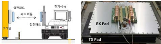
그림 3 위치정렬 장치 및 급전/집전 패드
