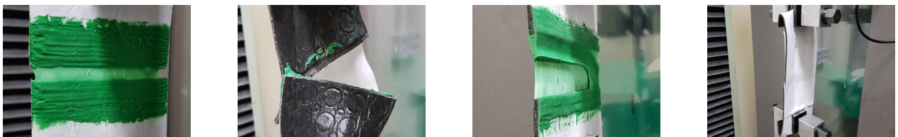
그림 7. 접합부 인장성능 시험 현황 (좌측부터 맞댐, 겹침, I형, 탑-다운 접합부)
