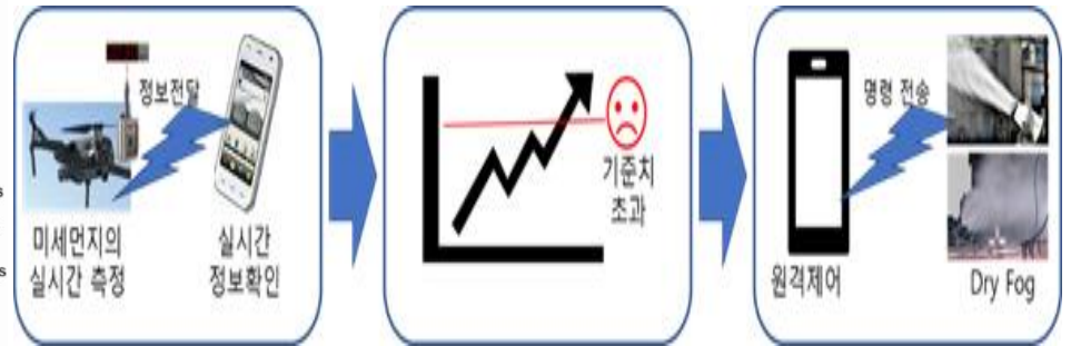
그림 2. 첨단 IoT 기반의 미세먼지 측정 및 대응 개념도 3)
