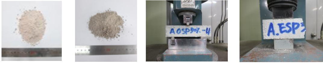
그림 1. 계란껍질 분말 그림 2. 굴 폐각 분말 그림 3. Bending strength 그림 4. Compressive strength
