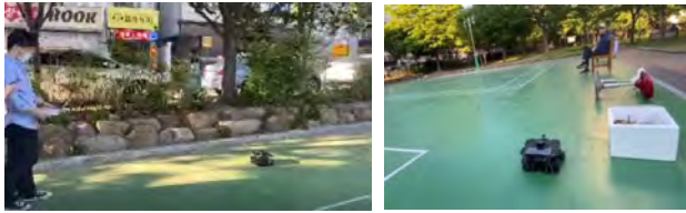
(그림 7) 사용자와 거리를 유지한 채 주행하는 로봇(왼쪽)과 지정된 경로를 일정속도로 주행하는 로봇(오른쪽)
