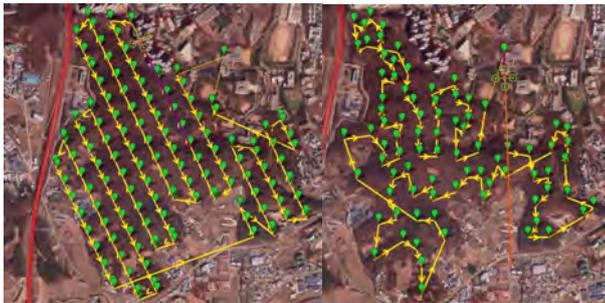
(그림 4) 좌측 Grid 우측 Shortest Path 알고리즘
