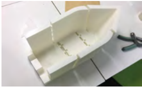
( 사진 4 ) 3D 프린터로 출력한 수상드론 선체
