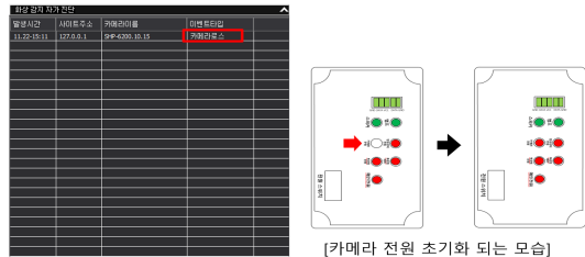
그림 3. 카메라 장애 판단 및 디스플레이 LED 표시
