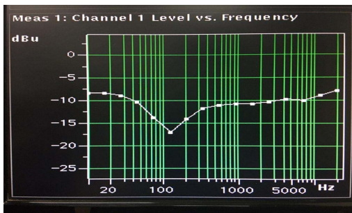
그림 10 회로동작 실험 (중심주파수 : 100Hz, Q=0.5)
