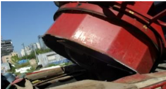
그림 1. 턴테이블 용접부 파손
