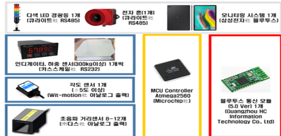
그림 3. 개발 시스템 구성도
