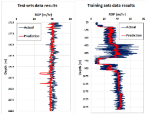
그림 2. LSTM 굴진을 예측 모델 학습 결과
