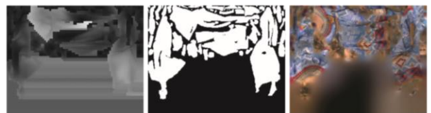
그림 1. 포인트 클라우드로부터 변환된 2 차원 영상의 예(1) 좌) Geometry, 중) Occupancy, 우) Texture
