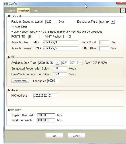
그림 11 자막 인코더 설정 창에서 TTML Offset 설정
