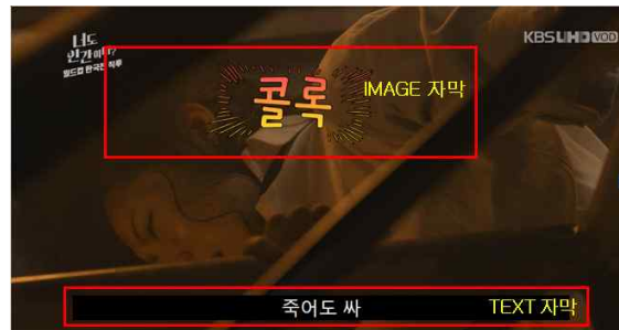
그림 16 감정 표현 자막 송출 시스템에서 송출한 신호를 셋탑 박스에서 수신해서 텍스트 자막과 이미지 자막을 재생 화면
