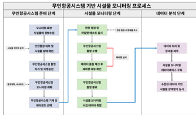
그림 2. 무인항공시스템 기반 시설물 모니터링 프로세스
