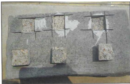
그림 1. 시멘트 액체 방수재의 부착성능 시험
