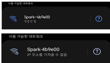
(그림 3) DJI Spark 고갈 공격 결과 일례 (위: 공격 전, 아래: 공격 후)
