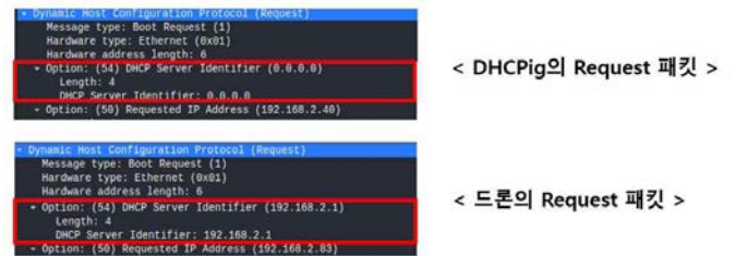
(그림 1) DHCPig를 사용한 드론 환경에서의 Request 패킷 분석 결과
