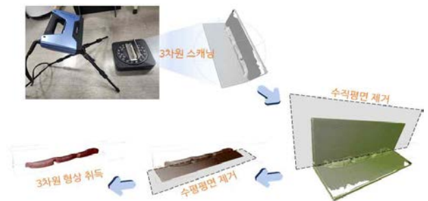
(그림 1) 접합부 3차원 형상 취득 개요
