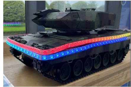
(그림 5) Neo Pixel LED를 이용한 발광부.
