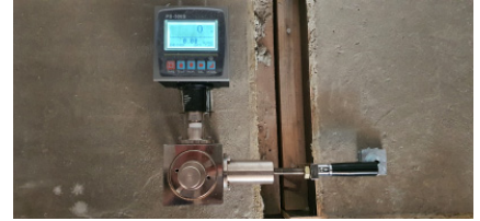
그림 3. 표면 부착강도 측정
