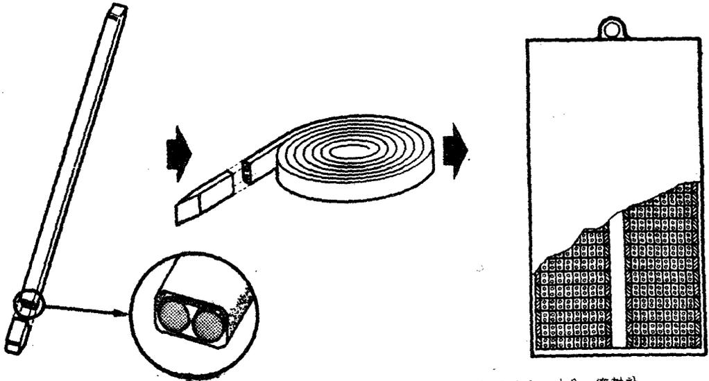
2 개의 既使用 燃料棒을 스테인레스鋼管안에 押込시킨 다음 密封한다. 密封한 鋼管을 코일모양으로 만든 다음 콘베이너에 輸入시키고 콘베이너를 溶接 密封시킨다.
