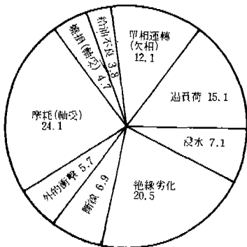
〈그림-1〉 國內에서의 電動機의 故障 [%]
