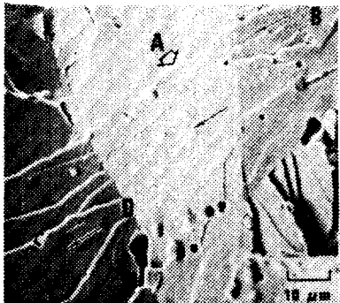
그림 8 劈開破壞 (A) 劈開段, (B) river pattern, (C) Tilt 粒界, (D) Twist 粒界, 가는 화살은 破壞方向을 나타냄 (1)
