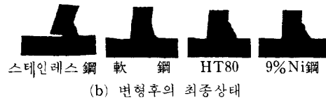
그림 14. 各種 鋼의 T形 試驗片의 熔接角變形
