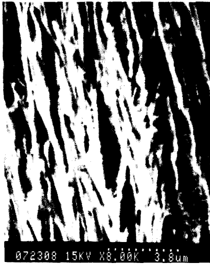
그림 4. 텅스텐 tip 표면의 갈모양 (×8000) Fig. 4. The grooves on the tungsten needle surface (×8000).
