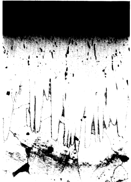
그림 10. 연강에 생성된 320 µm 단상의 Fe 2 B층
