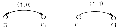
그림 3. (↑, s) 결합 고장 (i<j) (a) s=0 (b) s=1 Fig. 3. (↑, s) coupling fault. (i<j) (a) s=0, (b) s=1.
