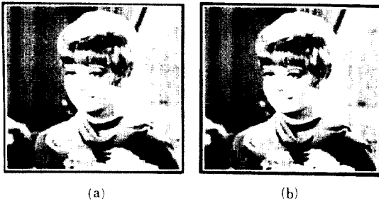
그림 5. 0.75 bpp에서 재생된 GIRL 영상 Fig. 5. Reconstructed GIRL image at 0.75 bpp. (a) SBC (b) SBC+HVS
