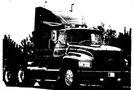
사진 1) 300 만불을 투자한 RTM 성형공법으로 제작된 트럭의 외형
