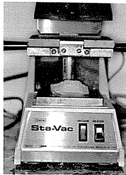
사진 1. 열을 가한 투명 레진 판을 석고 모형위에 압접해 splint 외형을 만드는 vacuum adpter.
