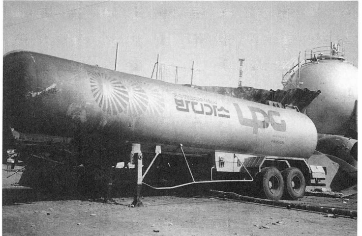
〈사고 탱크로리〉 보조 브레이크를 채우지 않아 비탈길을 미끄러져 저장 탱크와 충돌하여 사고가 일어났다. 폭발 방지 장치가 설치되어 폭발하지 않았다.
