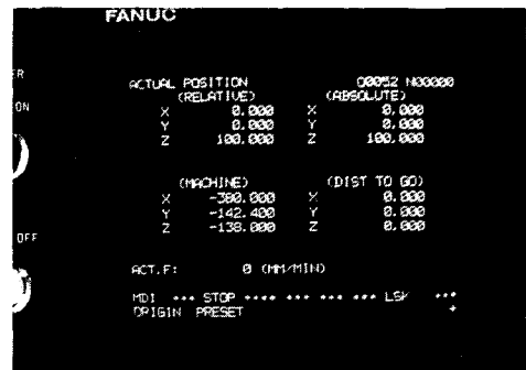
Fig. 16 CNC controller setting parameter
