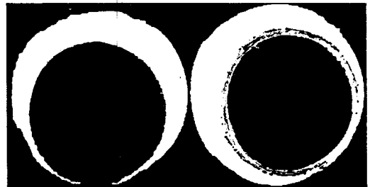
그림 33. Methanol에 담긴 3 cm 지름의 PMMA의 NMR Image(30°C). 왼쪽은 담근 직후에, 그리고 오른쪽은 48시간 이후에 측정된 것이다. 밖의 흰 부분이 순수 methanol이며, 안의 검은 부분이 PMMA에 해당되며 고체 상태이기 때문에 signal이 0이다. 사이의 옅은 부분이 PMMA 내부의 methanol이다(오른쪽 그림).
