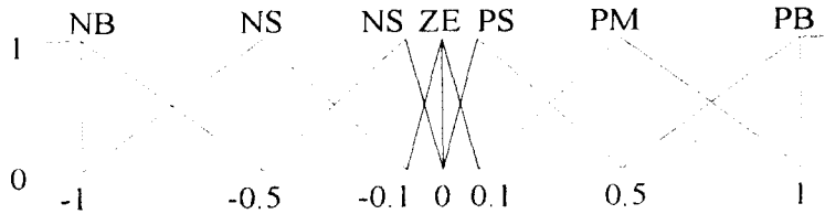
그림 4. 제어규칙에서 사용된 퍼지집합의 멤버쉽 함수 Fig 4. Membership functions of fuzzy sets used in the control rules
