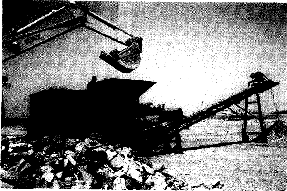
東亞建設이 국내 최초로 각종 건설현장에서 발생하는 콘크리트 및 아스콘 덩어리를 파쇄, 재활용할 수 있는 [건설 폐재 재활용 파쇄장비]를 개발했다. 이 장비는 自走式으로 강력한 파쇄는 물론 운반과 가동성이 뛰어나며 특히 분진을 적절하게 제어할 수 있다. 이 장비를 통해 생산된 폐골재는 주로 건축, 토목공사의 성토용, 복구용 및 도로 기층용, 포장타르, 아스팔트 혼합물 등으로 재활용할 수 있다.
