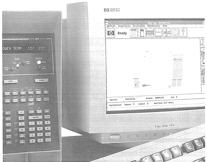
◇기체 크로마토그래프-질량검출기시스템의 기기 구성
