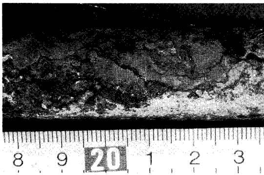
<그림 1.1> 강관의외면 부식과 공식으로 관통이 일어난 모습
