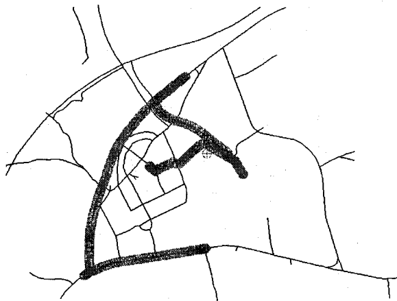
그림 44 데드 레코닝과 단순한 맵 매칭에 의한 주행 경로
