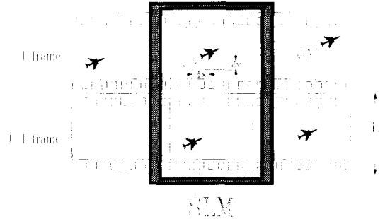
그림 1. 광 JTC 시스템 입력평면 구성
