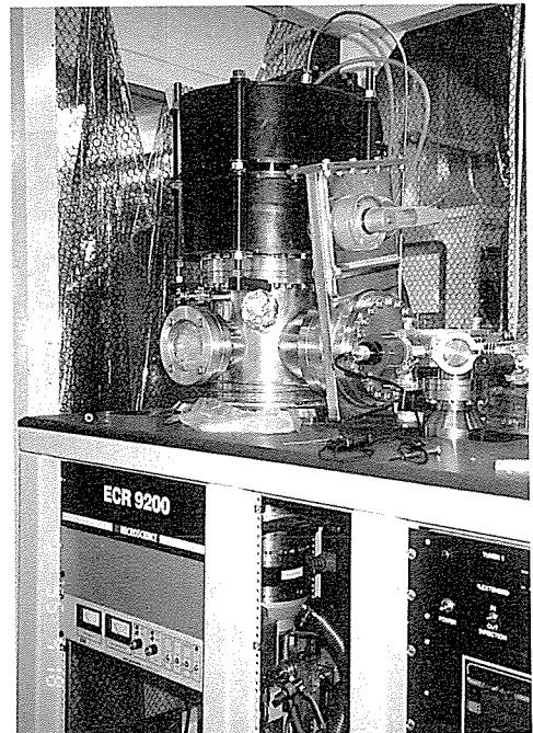
▲박막가공법을 하기 위한 ECR-CVD(Electron Cyclotron Resonance) 시스템
