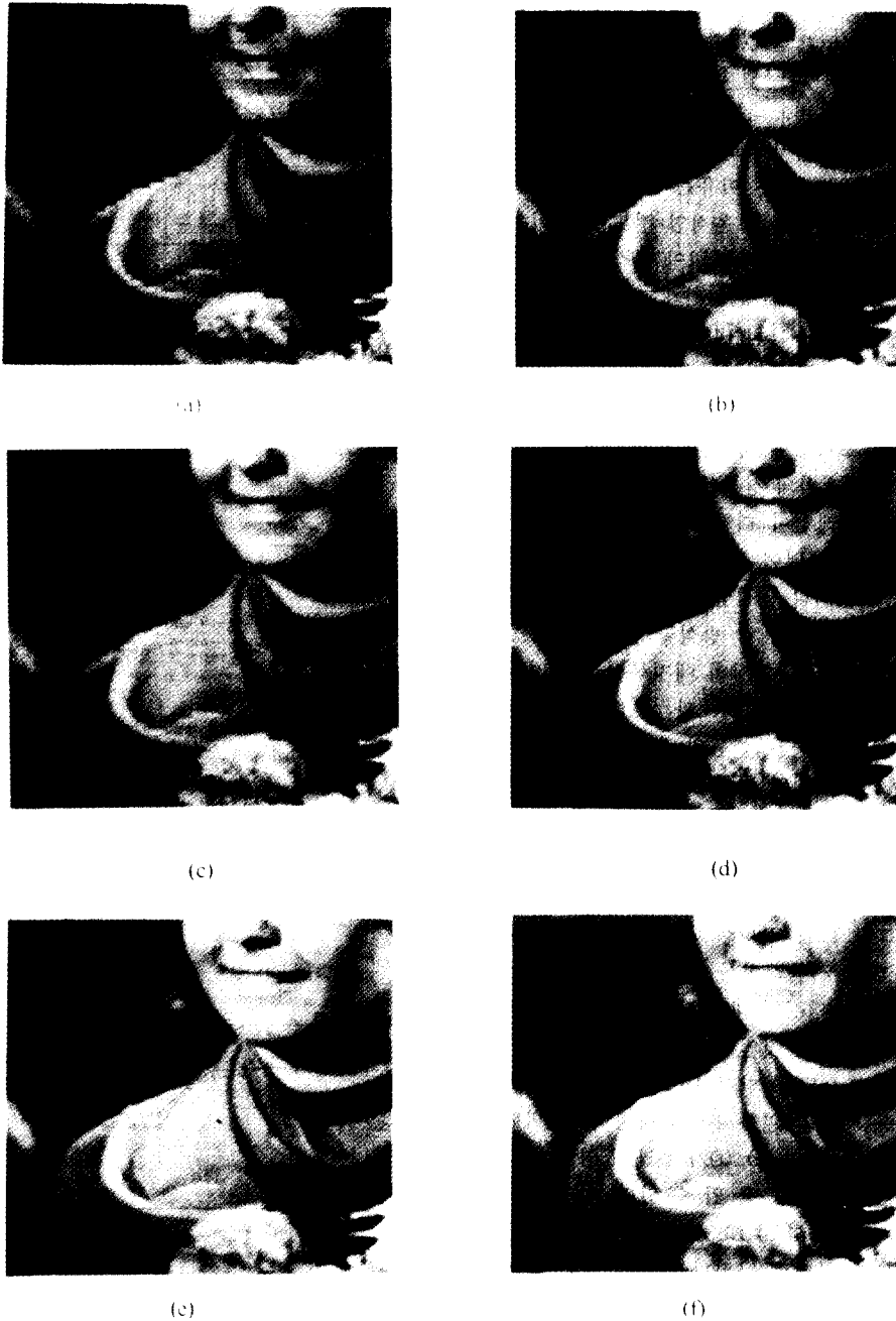
그림 18. 각 처리 방식에 의한 결과(GIRL) Fig. 18 The results of compared processing methods(GIRL) (a) ZOI (b) FOI (c) SWAI (d) Median filter (e) H-shaped PMED (f) Asterisk-shaped PMED
