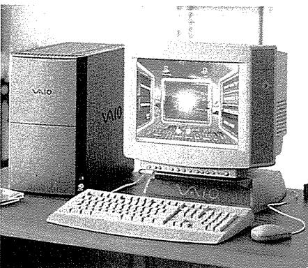
소니는 오디오와 비디오의 전문기술을 컴퓨터에 주입하여 신형 PCV-70과 PCV-90(그림)을 개발했다. 두개의 신형 컴퓨터는 모두 고속의 펜티엄 프로세서, 16MB메모리 그리고 8XCD-ROM 드라이브를 갖추었다. 그러나 이 PC의 진기는 입체 그래픽, 매끄러운 MPEG 모션 비디오 그리고 15인치 트리니트론 모니터와 3개 스피커시스템을 가진 특이한 비디오 디스플레이에 있다. 값은 2천달러와 3천달러 사이가 될 것으로 보인다.
