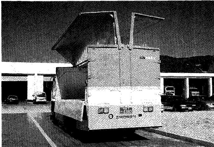
(사진 2) 비개방형 차량 Wing 동시개방 장면
