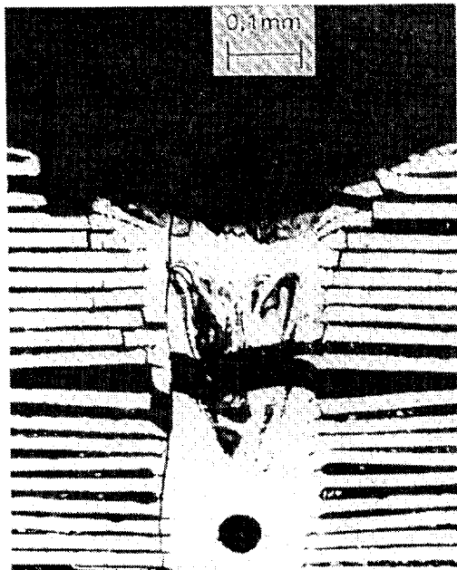
Fig. 5 용접시 weld nugget내에서의 용융체의 유동 현상을 관찰하기 위하여, 40장의 박판을 겹치기 용접한 용접부 단면 사진의 일부
