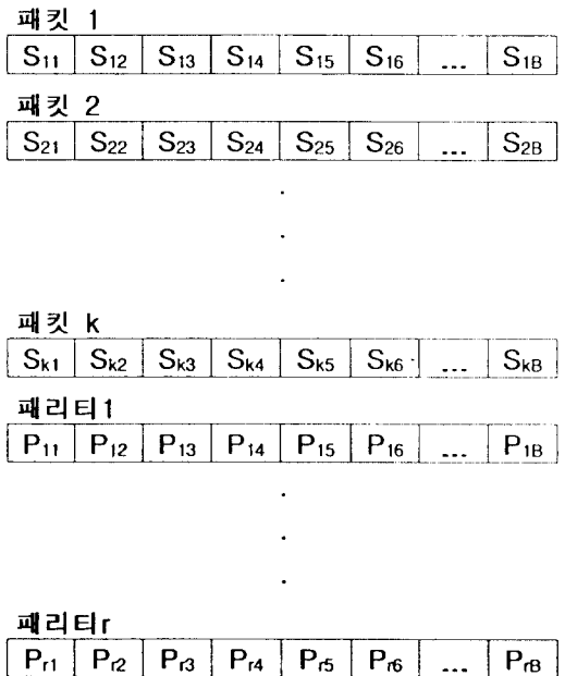
그림 3. MPE 프로토콜에서 사용하는 프레임 구조 Fig. 3 A frame for the MPE Protocol composed of k data and r parity packets
