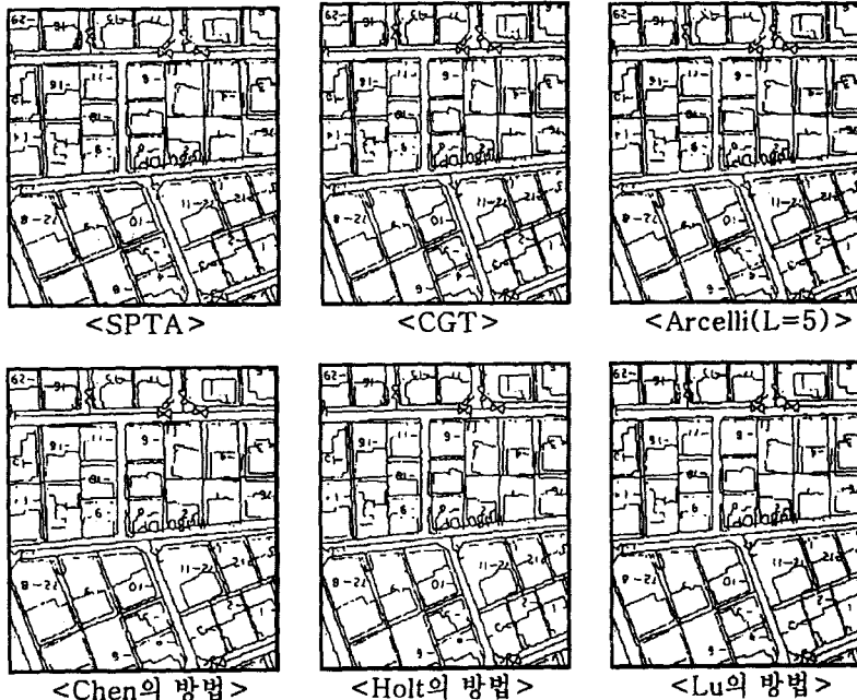
(그림 4) 상하수도1의 세선화 결과 (Fig. 4) Thinning result of water and sewer map 1.
