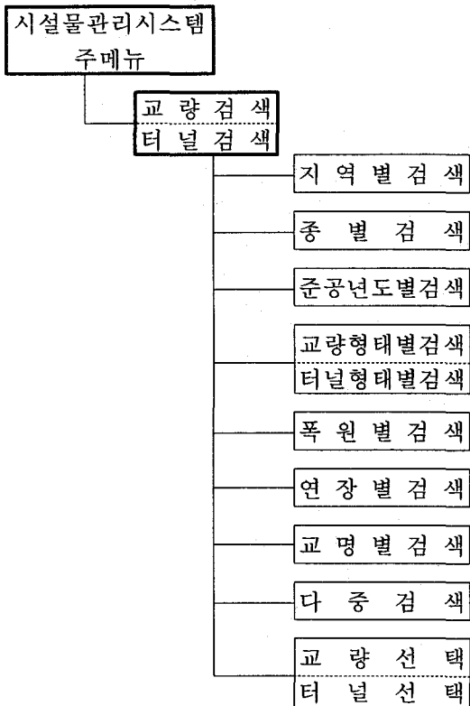
그림 32 시설물관리시스템의 교량 및 터널검색 메뉴구성
