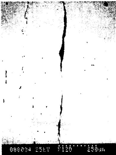
photo 4. 고주파 전기 저항 용접시 용접부에 형성된 침입 결함.
