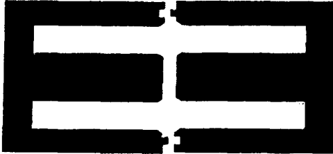
그림 4. 고효율 자기식안정기의 코어 형상 Fig. 4. The Core Shape of the Magnetic Ballast with High Efficiency.
