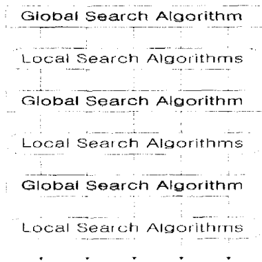
(그림 1) 일반 하이브리드 시스템의 구조 (Fig. 1) Structure of General Hybrid System
