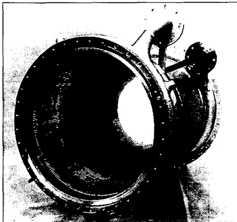
Fig. 12 액체 로켓트 엔진 관 구조 연소실
